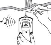
Sin soltar el botón de encendido/apagado, continúe explorando más allá del punto marcado hasta que se apague la luz roja que indica el borde "EDGE". Deslice la unidad en dirección opuesta hasta que localice el otro borde de la viga.
